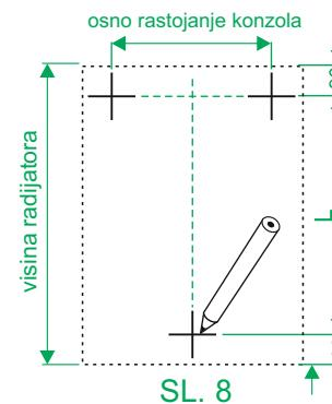
Na označenim mestima probušiti rupe (fi 8), postaviti tiplove i učvrstiti nosače konzola (B) vijcima M3 tako da vijak M1 bude okrenut na gore kod gornjih nosača, a na dole kod donjih nosača (da bi bio dostupan za zavrtanje). Libelom proveriti da li su gornji nosači konzole na istoj visini (horizontalni).
